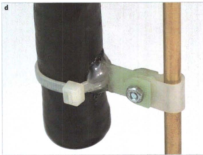
Figur 5. Detaljer av prototypen: (a) basplatta (kylelement av aluminium), (b) Hallsensor, (c) mässingsrör med ledarna för spolen, (d) spolfäste med buntband.
