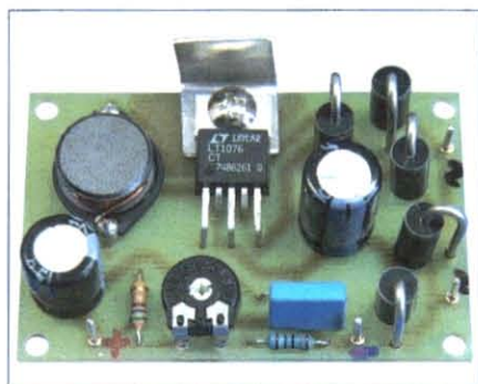
Figur 6. Mycket kompakt prototyp av switchingsregulatorn.
