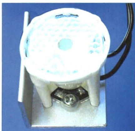
Figur 7. LED-en, monterad på sitt bärkort, och linsen skruvas fast på en bit aluminiumprofil och bildar en lampmodul.
