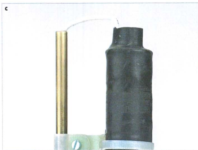
Figur 5. Detaljer av prototypen: (a) basplatta (kylelement av aluminium), (b) Hallsensor, (c) mässingsrör med ledarna för spolen, (d) spolfäste med buntband.
