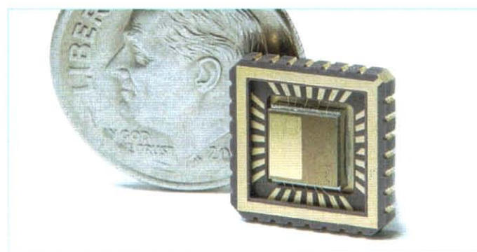
Figur 11. SensorChip-CO 2 är ett MEMS-chip för att mäta CO 2 (bild: ICX Technologies).
