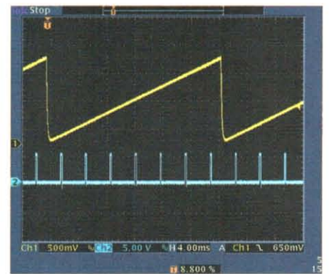
Figur 9. Oscilloskopkurvorna visar sågtandsvågen 8filterad PWM-signal och LED:ens drivpuls.
