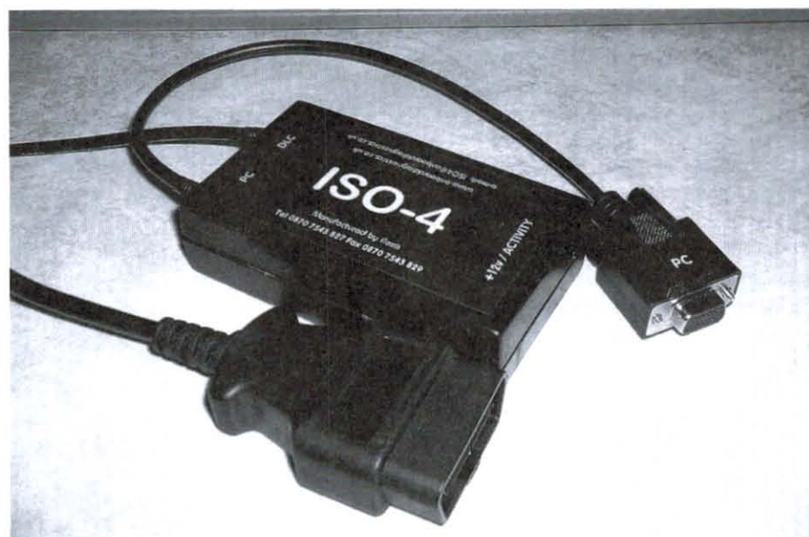
Figur 6. För att använda PC-baserad mjukvara behövs det en lämplig adapterkabel, som inkluderar en mikrokontroller som anpassar de två interfacen till varandra. (Källa: Onboard Diagnostics).
