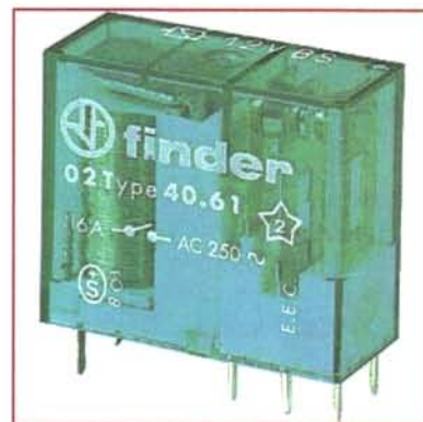
Figur 9. Det bistabila remanentrelä som användes i prototypen.
