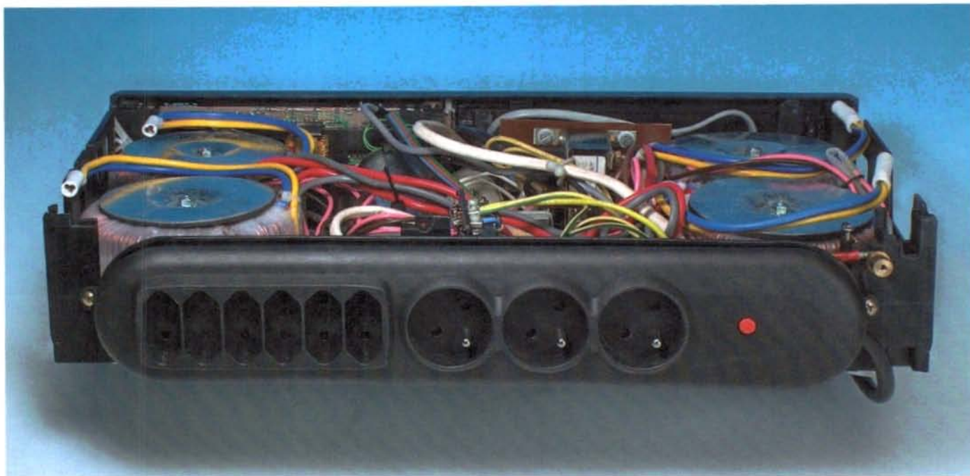
Författaren parallellkopplade två transformatorer i prototypen så att de skulle ta mindre plats och så att hela filtret fick plats i en lägre låda.
