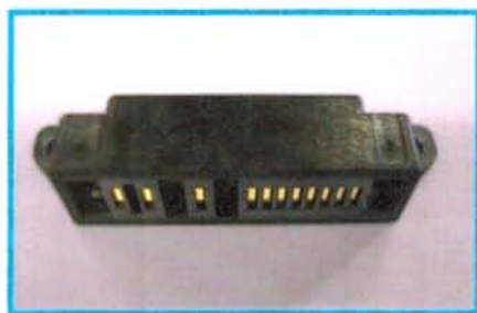
Figur 6. Programmeringen sker via denna kontakt på telefonblisten. En matchande kontakt till denna kan köpas på Internet.
