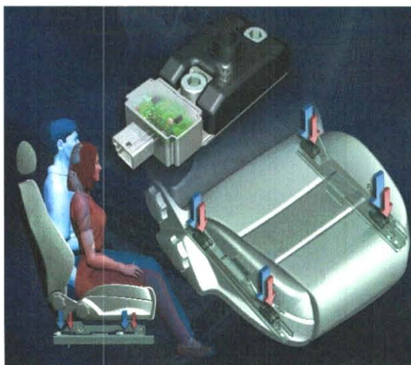
Figur 7. Trycksensorer vid fästpunkterna i golvet känner av om stolen är upptagen av en passagerare.
