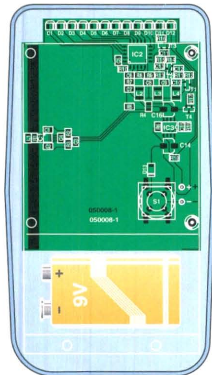
FIGUR 3. Kretskortslayout och komponentplaceringsritning för det kretskort som tagits fram för testaren. Dipolantennen är en striplinekrets.
