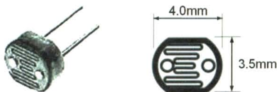
Figur 5. LDR-en är inte kalibrerad efter några enheter för ljusstyrka. Den läser i stället i termer av 'procent av fullt solljus' där 0% motsvarar frånvaron av ljus och 100% motsvarar den maximalt förväntade ljusstyrkan vid fullt solsken.
