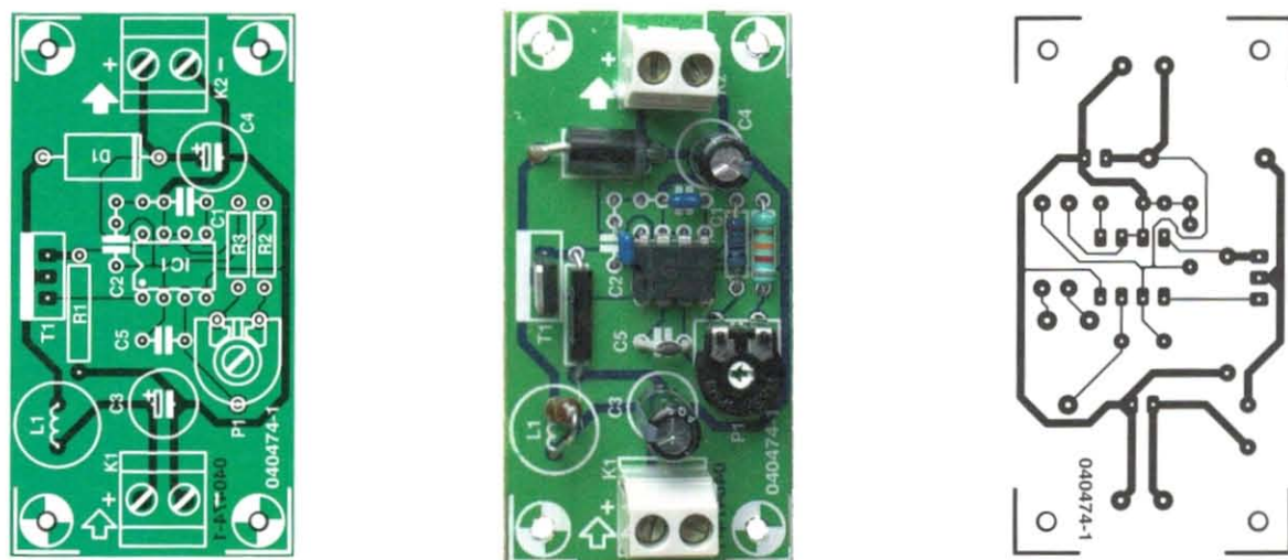
Figur 2. Kretskortslyout och komponentplaceringsritning för batteriladdaren.
