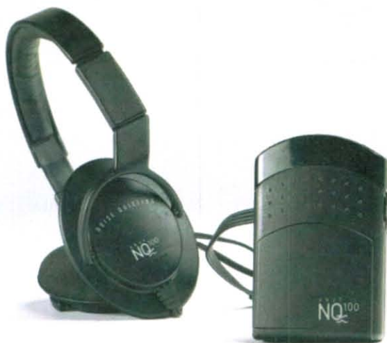
Figur 6. Typiska billiga ANR-hörlurar för att lyssna på musik i bullriga omgivningar. Elektronikboxen ansluts till signalkällan (stereo etc) och länkas till hörlurarna, som inkluderar två mikrofoner och en 8-polig skärmad kabel.
