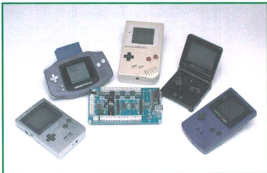
Figur 1. Lämpliga GameBoy modeller. Enheten i mitten är en GBPLC I2C I/O Box, som driver den GameBoy som är försedd med en GBPLC modul.
